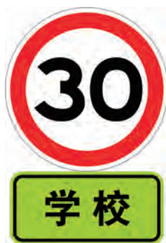
图 65 学校区限制速度标志设置示例
