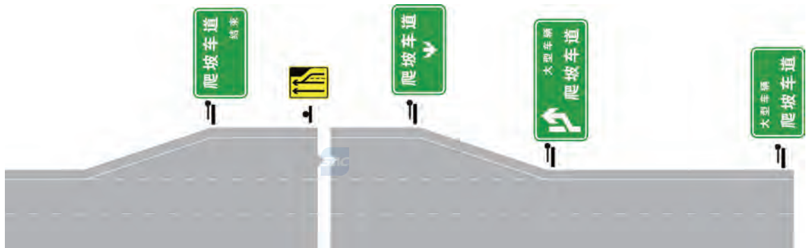
图 301 爬坡车道标志设置示例
