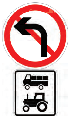
图 43 禁止向左(或向右)转弯标志加辅助标志示例
