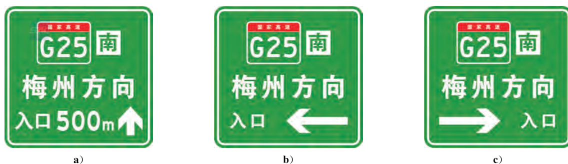
图 251 入口预告(进入后 1 个方向)(路 30)
