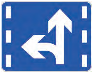
图 103 直行和左转合用车道(示 21)
