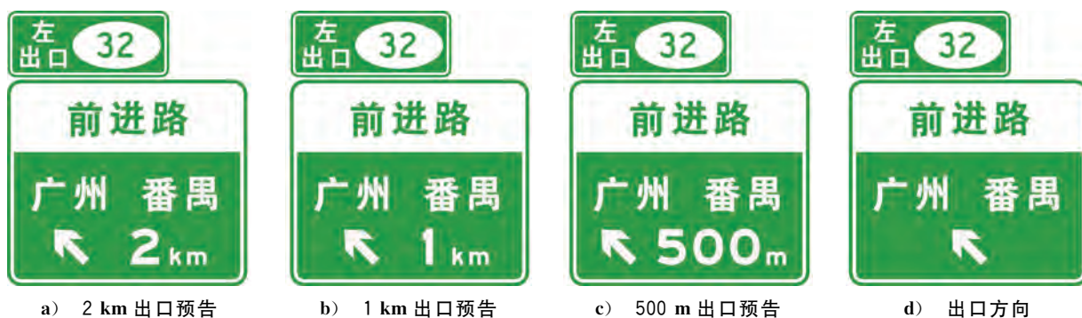
图 265 一般互通式立体交叉出口后道路无编号的出口预告(路 44)及出口方向(路 45)
