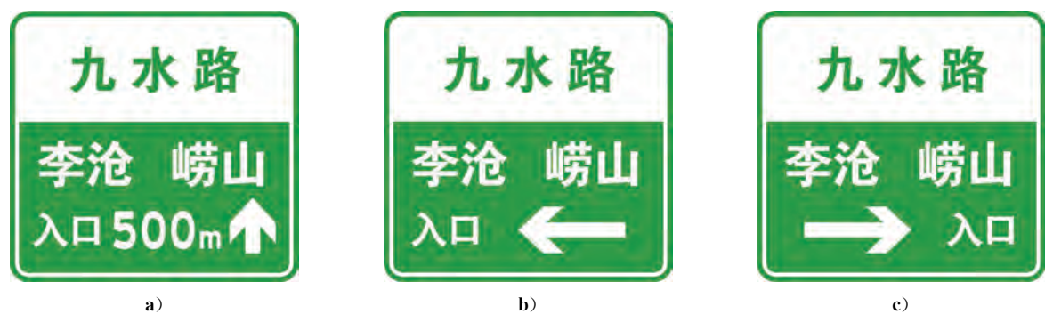
图 252 无编号高速公路或城市快速路入口预告(路 31)
