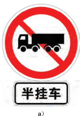
图 27 禁止挂车、半挂车驶入标志加辅助标志示例
