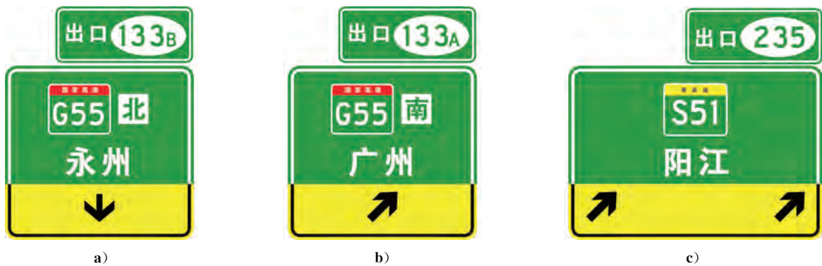
图 270 直出车道出口方向(路 48)
