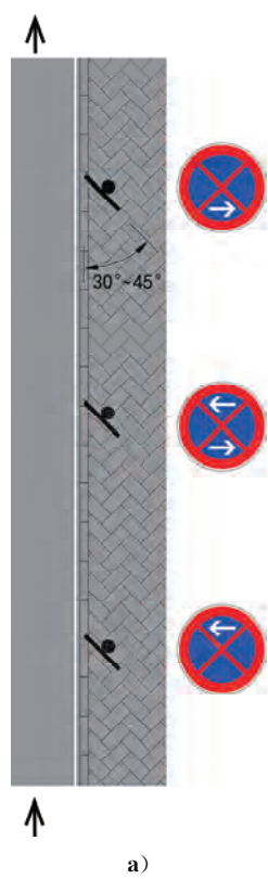
图 56 表示范围的禁止车辆停放标志设置示例
