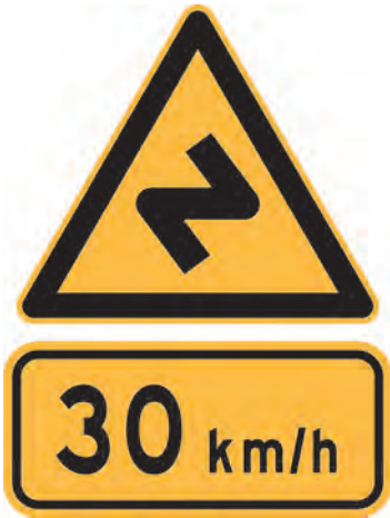
图 144 反向弯路标志和建议速度标志联合使用示例
