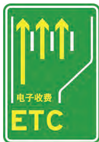
图 295 电子不停车收费(ETC)车道指引(路 71)
