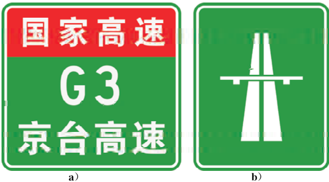
图 C.2 编号标志和起点标志并设示例
