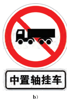
图 27 禁止挂车、半挂车驶入标志加辅助标志示例
