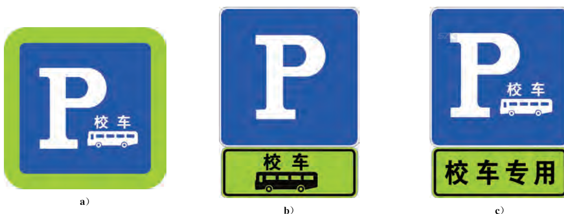
图 128 校车专用停车位标志、校车停靠站点标志示例
