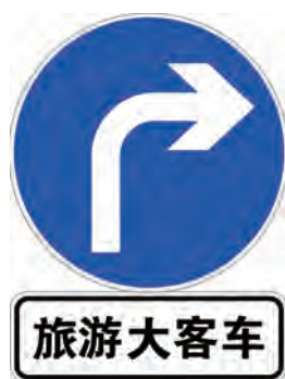
图 81 向右转弯标志加辅助标志示例
