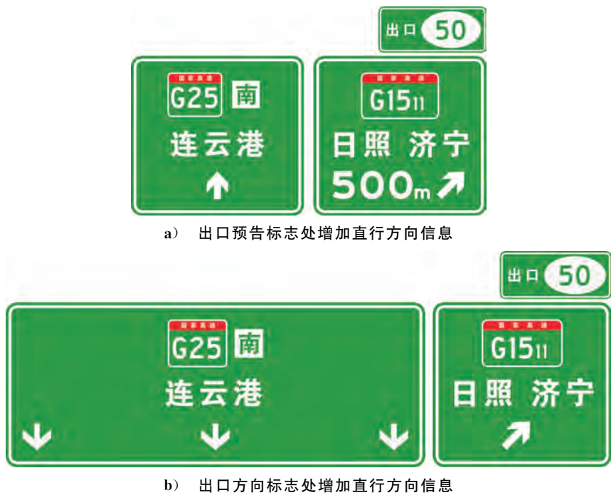
图 269 枢纽互通式立体交叉出口增加直行方向信息示例
