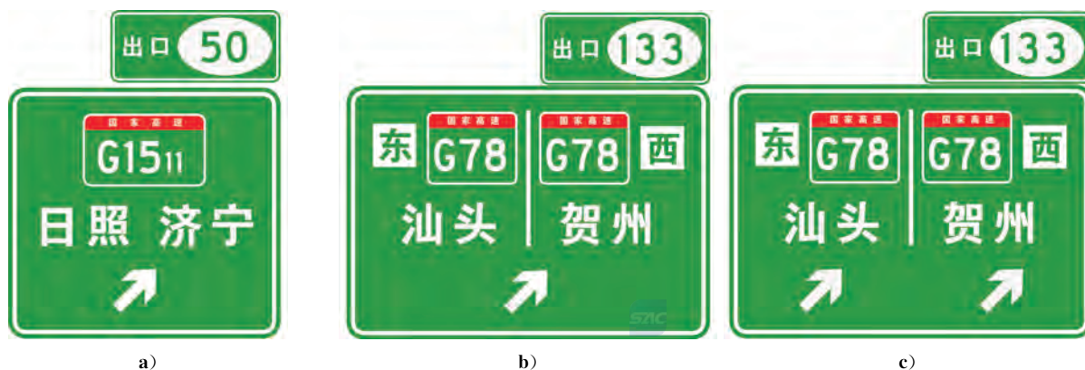
图 267 枢纽互通式立体交叉出口方向(路 47)
