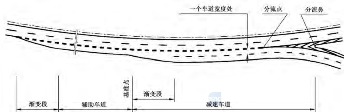
c) 设辅助车道的平行式双车道出口
