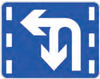
图 105 掉头和左转合用车道(示 23)
