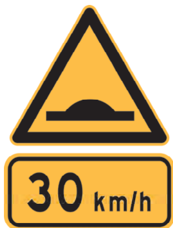
图 176 减速丘标志和建议速度标志(警 38)联合使用示例
