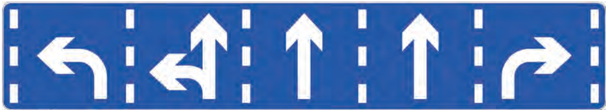
图 106 组合设置的分向行驶车道标志示例
