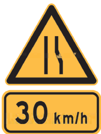
图 153 窄路标志和建议速度标志联合使用示例
