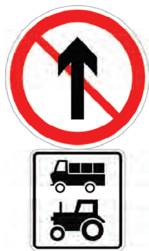
图 45 禁止直行标志加辅助标志示例
