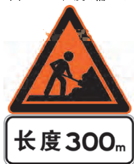
图 338 长度辅助标志的使用示例
