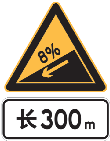
图 150 陡坡标志加坡度值及辅助标志示例
